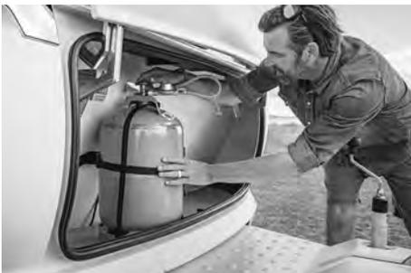
Positionierung der Gasflasche im Gasflaschenkasten
