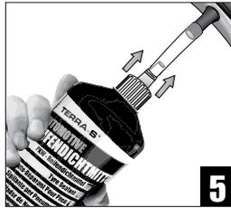
Einfüllschlauch auf Reifenventil aufschrauben
