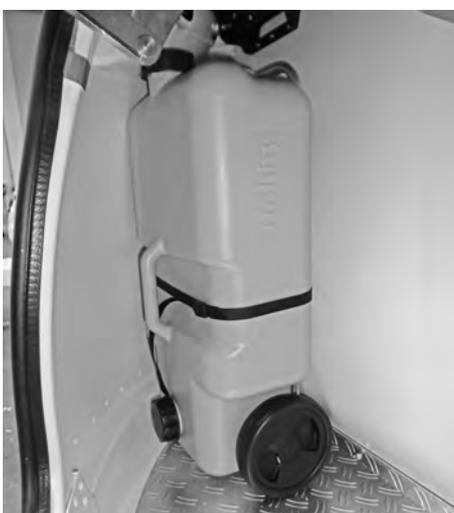
Abwassertank im Gasflaschenkasten
