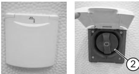
Einfüllstutzen für den Frischwassertank
