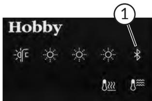
1. Aktivieren Sie die Bluetooth-Funktion am Bedienpanel des Fahrzeuges. Gehen Sie wie folgt vor:
