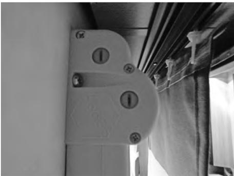
Rollos nicht über einen langen Zeitraum geschlossen lassen. Falls ein Rollo mit der Zeit an Spannung verliert, können Sie mit einem Schlitzschraubendreher die Rollospannfeder nachspannen. Hierzu den Schraubendreher einstecken und ein bis zwei Umdrehungen im Uhrzeigersinn drehen.
